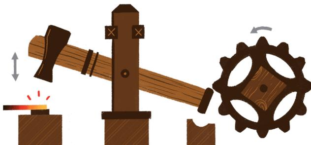
Dès le Moyen Âge, dans les forges, on utilisait cette machine pour travailler le fer. La force de l'eau la faisait fonctionner. Observe bien le lourd marteau à bascule qui vient tomber sur l'enclume. Cela permet d'aplatir le fer.
